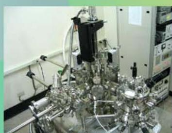
奈米結構實驗室 - 超高真空原子束磊晶與掃描
